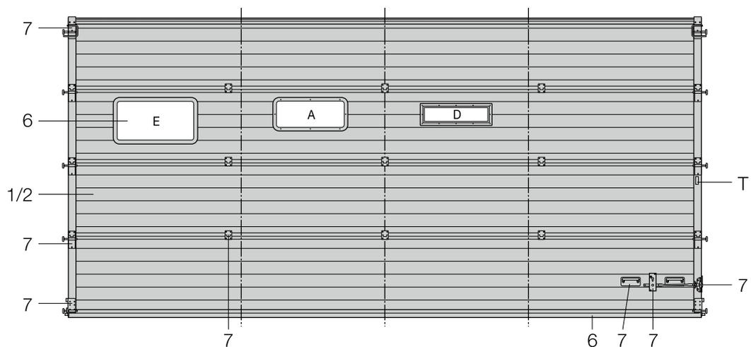
**1/2** Двустенные секции ворот 42 мм / 67 мм
