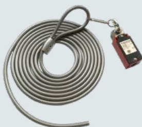
Выключатель с тяговым шнуром из пластмассы Возможен монтаж в вертикальном или горизонтальном положении, отлитый под давлением алюминиевый корпус, IP 65, длина шнура 4 м
