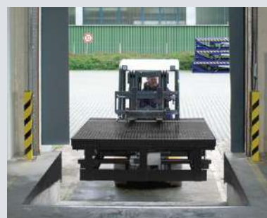
Установить новый перегрузочный мост
